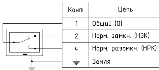
Рисунок В2б. Электрическая схема подключения реле давления
