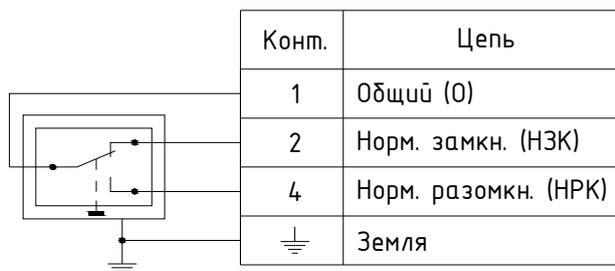
Рисунок Б2б – Электрическая схема подключения реле давления
